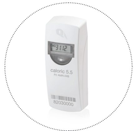
Le nouveau répartiteur de frais de chauffage Q caloric 5.5 émet en parallèle des télégrammes walk-by et AMR.
